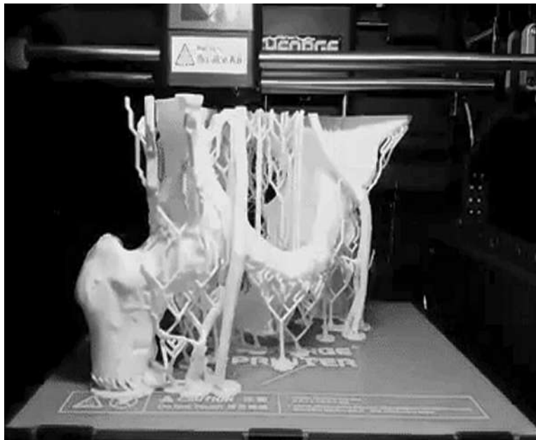
Рис. 5. Процес 3D-друку кісток таза
