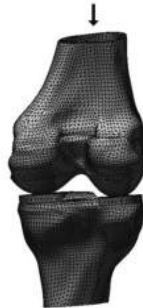
Рис. 4. Конечно-элементная модель кинематической цепи
