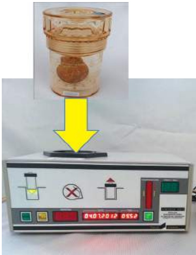
Рис. 5. Схема термостерилізаційної обробки головки стегнової кістки за допомогою системи локального кісткового банку (пояснення в тексті)
